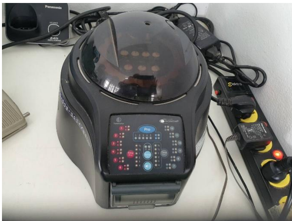
อุปกรณ์สำหรับตรวจสอบประสิทธิภาพการปราศจากเชื้อ
